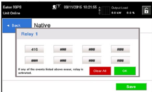
29. ábra: A relét befolyásoló funkciók kódjainak megadása.
