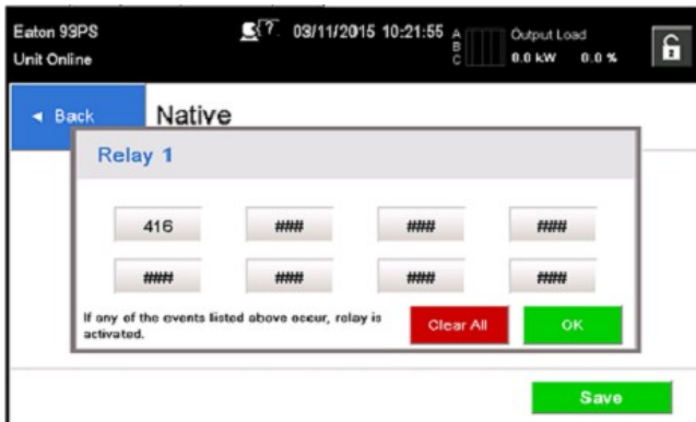
35. ábra: A relét befolyásoló funkciók kódjainak megadása.
