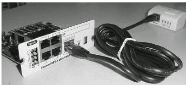
25. ábra: ConnectUPS-X SNMP/Web modul a környezetfigyelő szondával
